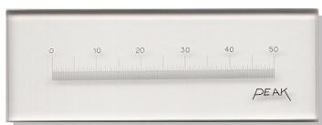
Die Mikrometerskala dient der Kalibrierung von Videobildern und BV-Software. Die kontrastreiche Skalierung ist auf einem Glaskörper aufgebracht.
